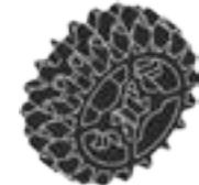
2x - Double engrenage conique, 20 dents, noir. N° 6093977
