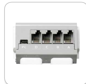
Connexion des moteurs
